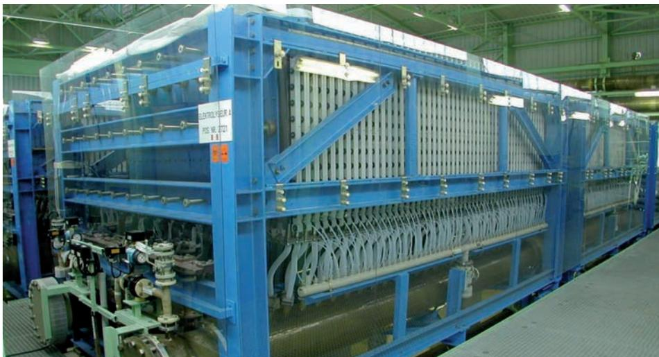
Die Verbesserung der Energieeffizienz ist eines der wichtigsten Unternehmensziele bei Vinnolit. 2012 wurden die Membranen der modernen Chlor-Elektrolyse in Knapsack erneuert, um den Stromverbrauch noch weiter zu senken.
